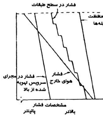
شکل ۱۲۷ - مشخصات فشار در ساختمان دارای الگو «و»
